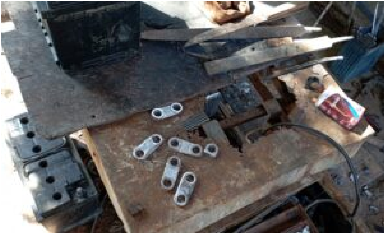
Puentes de plomo caseros. (Foto del autor)
